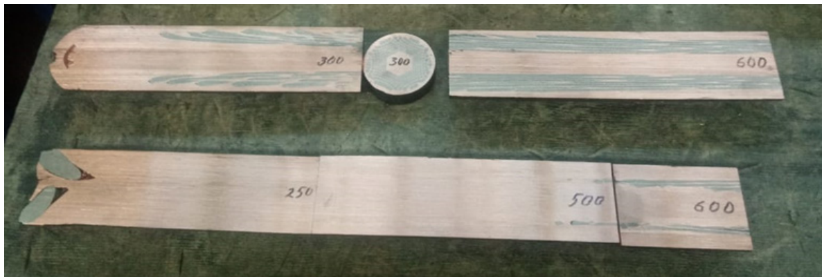
Рис. 6. Продольные шлифы переднего (верхний) и заднего (нижний) концов прутка №1 с неустоявшейся геометрией.
