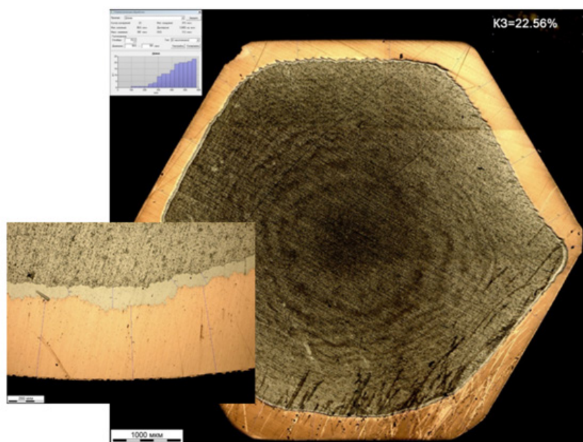
Рис. 4. Сечение триметаллического Cu/Nb/NbTi прутка размером под ключ S4.5 мм от переднего конца прутка. На вставке представлено место нахлеста листового ниобиевого барьера.
