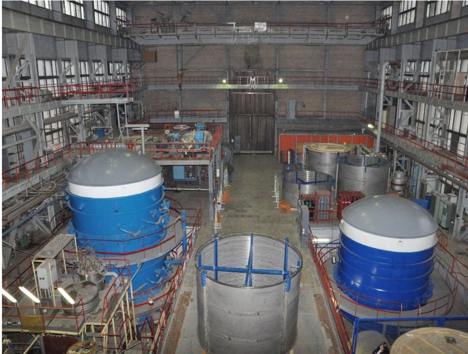
Рис. 3. Испытания токонесущих элементов для обмоток тороидального поля ИТЭР. Большой экспериментальный зал СИМС в НИЦ «Курчатовский институт»
